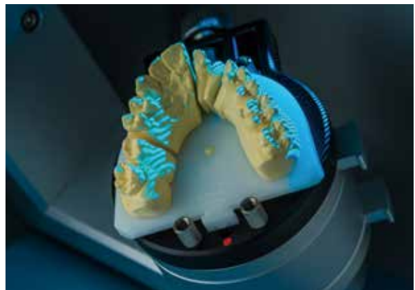
在DS30蓝光扫描仪上扫描的牙齿模型
