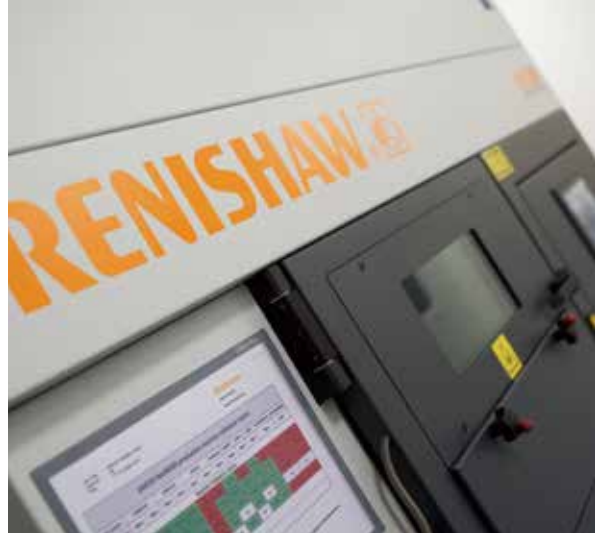
雷尼绍的AM250增材制造系统（金属3D打印）
